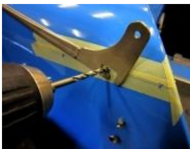
afb.3 Het boren van het gat in de zijkant van de body
