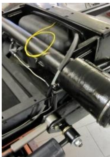
Rem- en benzineleiding bij achteras
