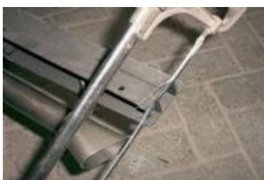
Afzagen achterzijde chassis
