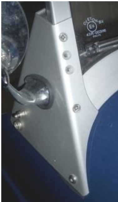
afb. 1 Draai 2 schroeven uit het voorruitframe
