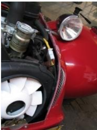
Kabelboom langs koelhuis
