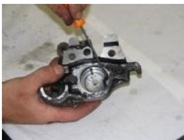
Rubber ringen verwijderen
