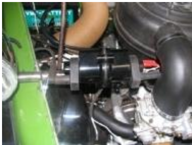
Plaats van de bobine op de beugel
