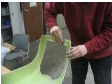
Vlakschuren voor slotvanger
