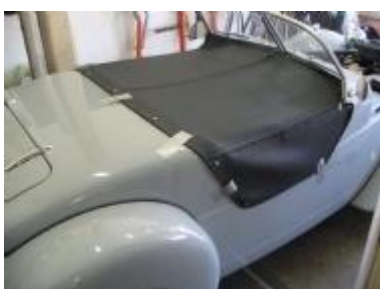
Cover vastzetten met duct-tape
