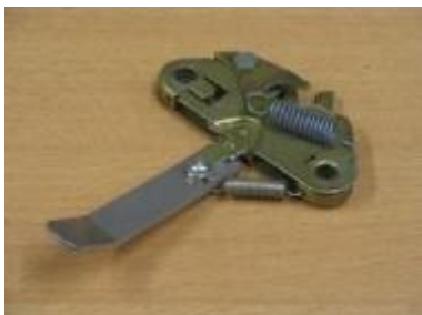
Motorkapslot met hendel
