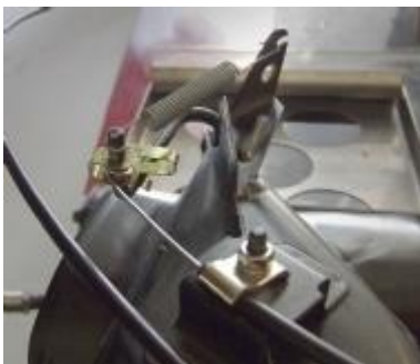
Kachelpot rechts (bevestiging korte kabel)
