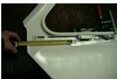
Uitmeten 200mm slotplaat
