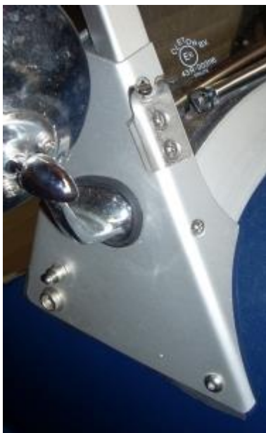
afb. 2 Haak bevestigen aan voorruit
