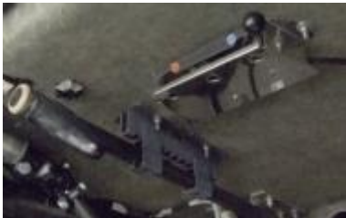
Kachelbediening RVS, onder dashboard naast handremhandvat
